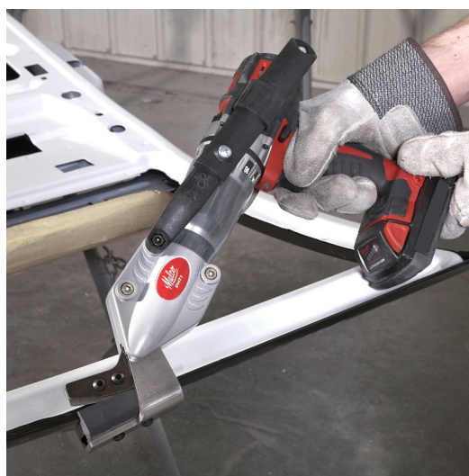
Fig.9. Cap modular pentru îndoiri margini fețe de portiere (Varianta electrică 14.4 v/220v).
