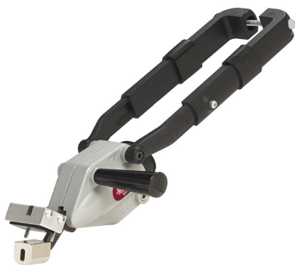
Fig.7. Cap modular pentru îndoire și închidere arce aripi automobile (Varianta electrică 14.4 v/220v)
