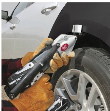
Fig.8. Cap modular pentru îndoire și închidere arce aripi automobile (Varianta electrică 14.4 v/220v)
