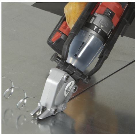
Fig. 3 Tăierea tablei de oțel de calitate pentru automobile (Varianta electrică 14.4 V)
