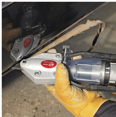
Fig.5. Cap modular de tăiere metal prin forfecare (Varianta electrică 14.4 V)
