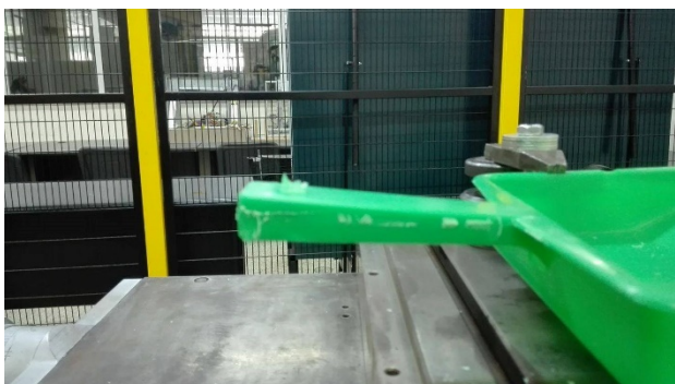
Fig. 19. Rezultate necorespunzătoare la debavurarea părții din spate a fârașului
