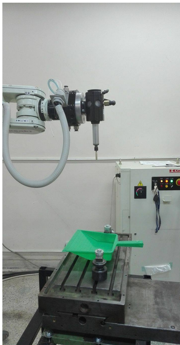
Fig. 10. Programarea prin instruire a robotului în vederea realizării aplicației de debavurare
