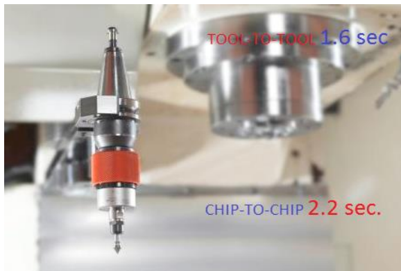
Fig 11. Sistemul automat de schimbare a sculei[5]
