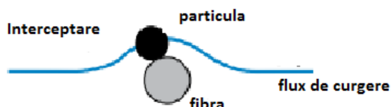
Fig.7 Interceptarea particulelor în filtrul HEPA[4]
