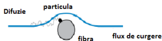
Fig.6. Difuzia particulelor în filtrele HEPA[4]
