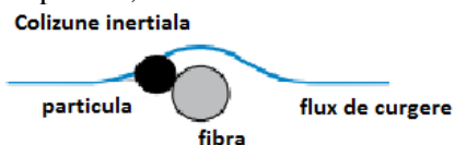
Fig.5 Coliziune a particulelor în filtrul HEPA[4]
